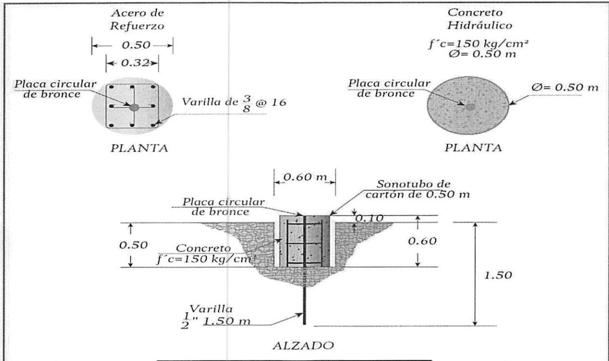
Ilustración Diseño de mojonera de concreto (Isométrico)
