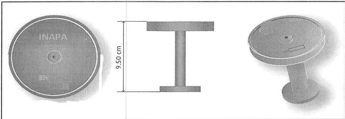
Ilustración Diseño de una mojonera de concreto
