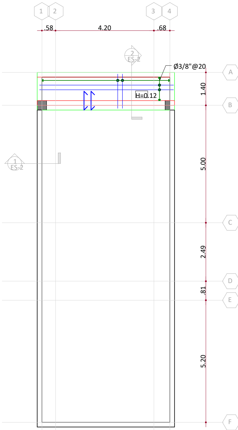
2 ES-3 Esc. 1 : 100 PLANTA ESTRUCTURAL DE TECHO COTA +6.85
