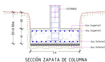
SECCION ZAPATA DE COLUMNA
