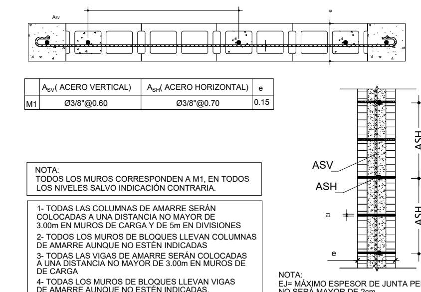
DRM DR-13 DETALLE REFUERZO MAMPOSTERÍA ESC.: 1:20
