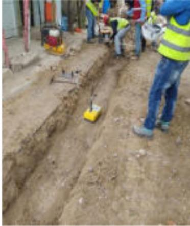
Calibración de equipo de prueba de compactación
