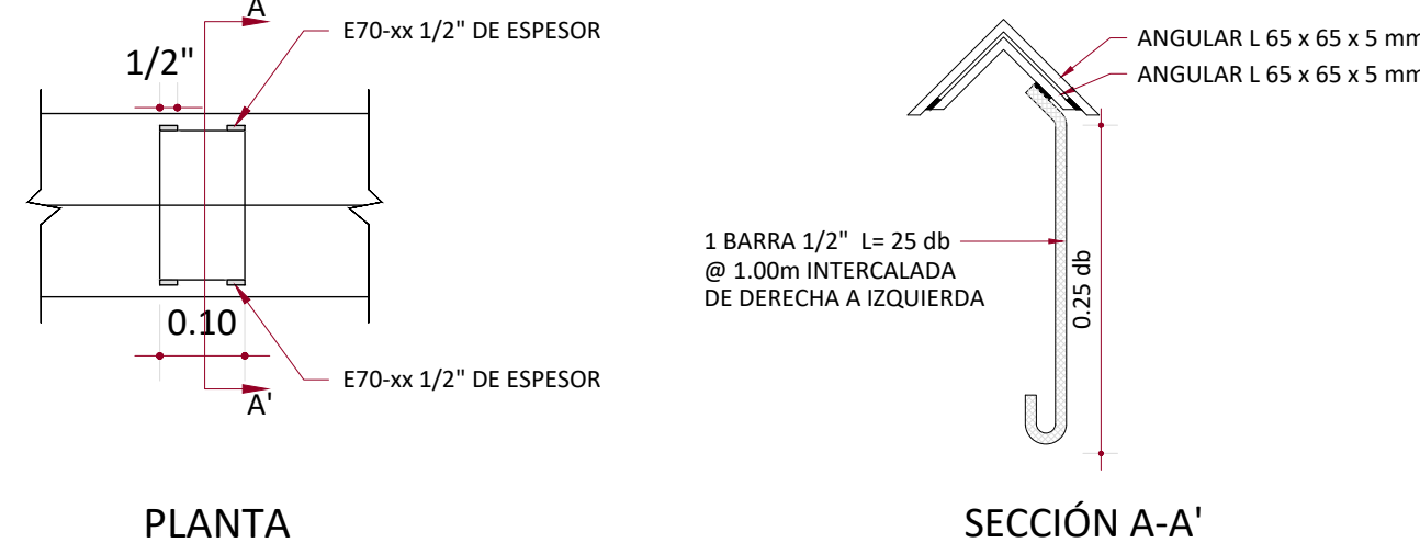
PLANTA Y SECCIÓN A-A' DE RIEL ESC. 1:15
