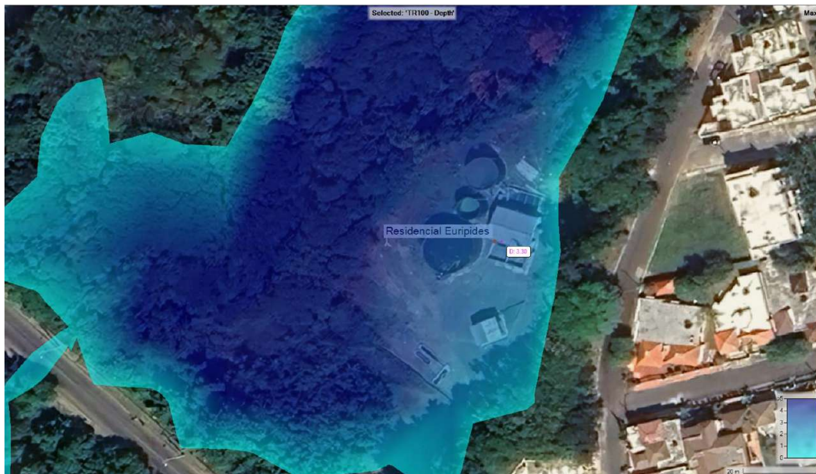
Figura 6.17. Inundación para evento con tiempo de retorno de 100 años PTAR en Residencial Eurípides. Profundidad Máxima: 3.30 metros
