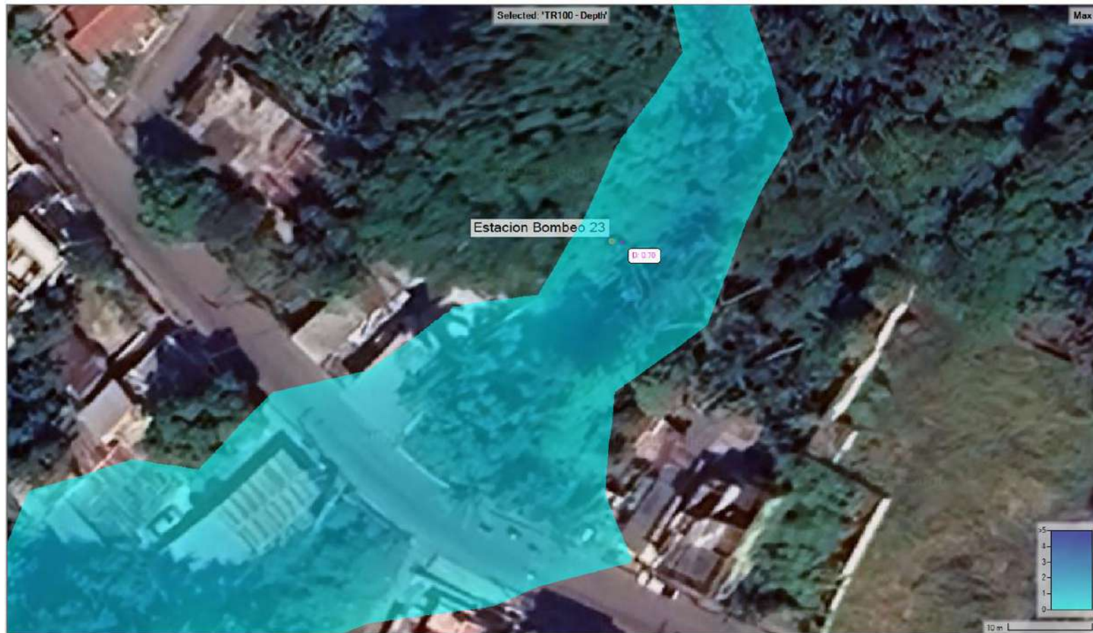
Figura 6.18. Inundación para evento con tiempo de retorno de 100 años estación de bombeo 23. Profundidad Máxima: 0.70 metros
