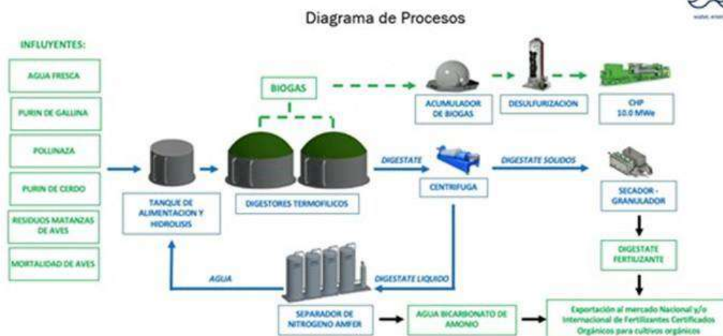
Figura 9.3. Diagrama del proceso de la planta de A-BIO
