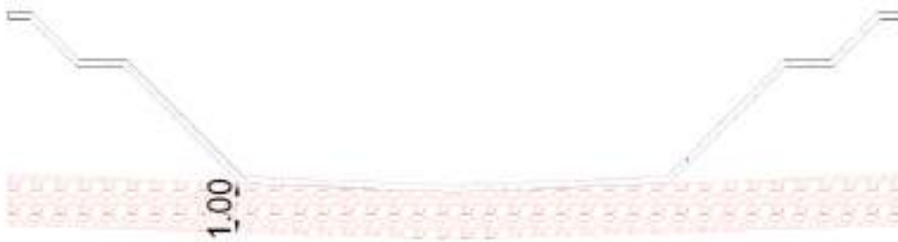
SECCIÓN DE GRANZOTE PARA SANEAMIENTO DE FONDO DE CANAL 1 14 Esc. 1:50
